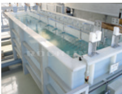
Polystone® P Homopolymère naturel Bassin d'anodisation pour le traitement de poignées de portes
